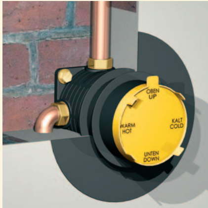
2. Verputzen und Dichtmanschette aufkleben.
